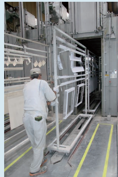
乾燥炉に台車をセット ▲
