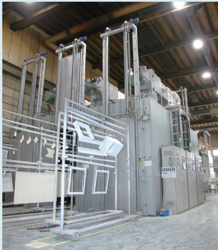
▲ 中赤外線とガスによるハイブリッド連続乾燥炉が3基並ぶ
