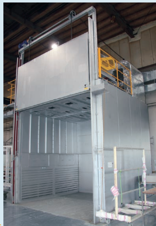
大物ワーク用の自動扉式固定乾燥炉 ▶
