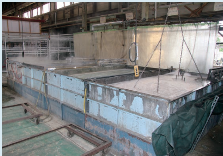
▲ 浸漬(しんせき)方式の前処理装置
